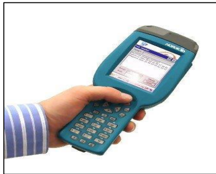
Εικόνα 1: Αναγνώστης RFID ετικέτας
