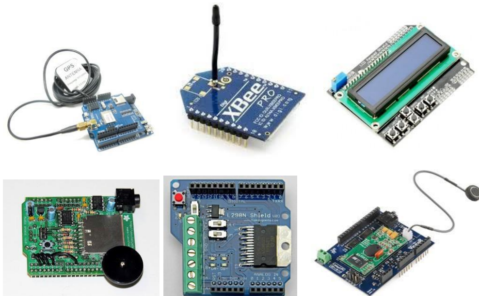
Εικόνα 12 - Arduino Shields από πάνω αριστερά προς τα κάτω: Xbee shield, GPS shield, voice recognition shield, LCD shield , motor shield, wave shield
